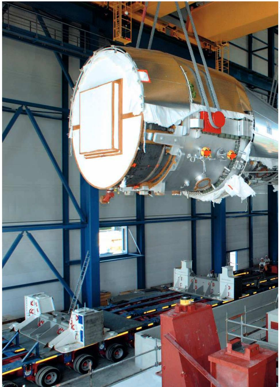
**GIGANTISCH** Von Mitarbeitern kritisch beäugt (links unten) – eine Gasturbine, die 440 Tonnen wiegt und 340 Megawatt leistet. Damit ist sie so stark wie ganze 13 Jumbo-Triebwerke zusammen.
