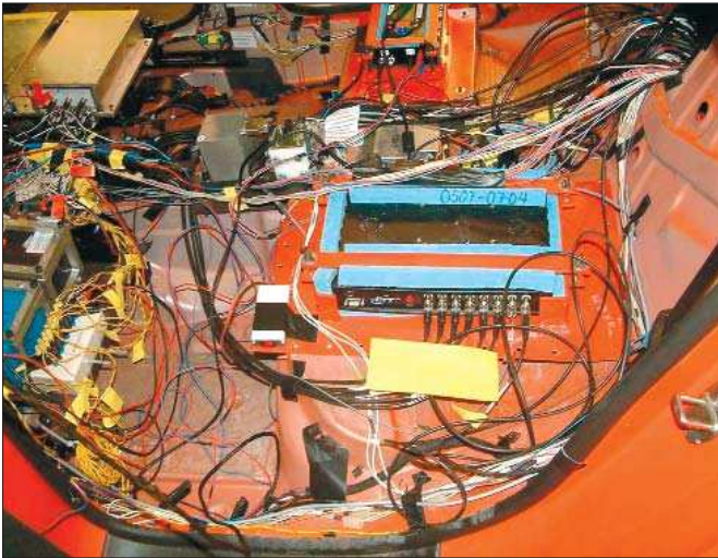
! Bild 5. Der Recorder LTT186-16 eingebaut in ein Crashfahrzeug.
